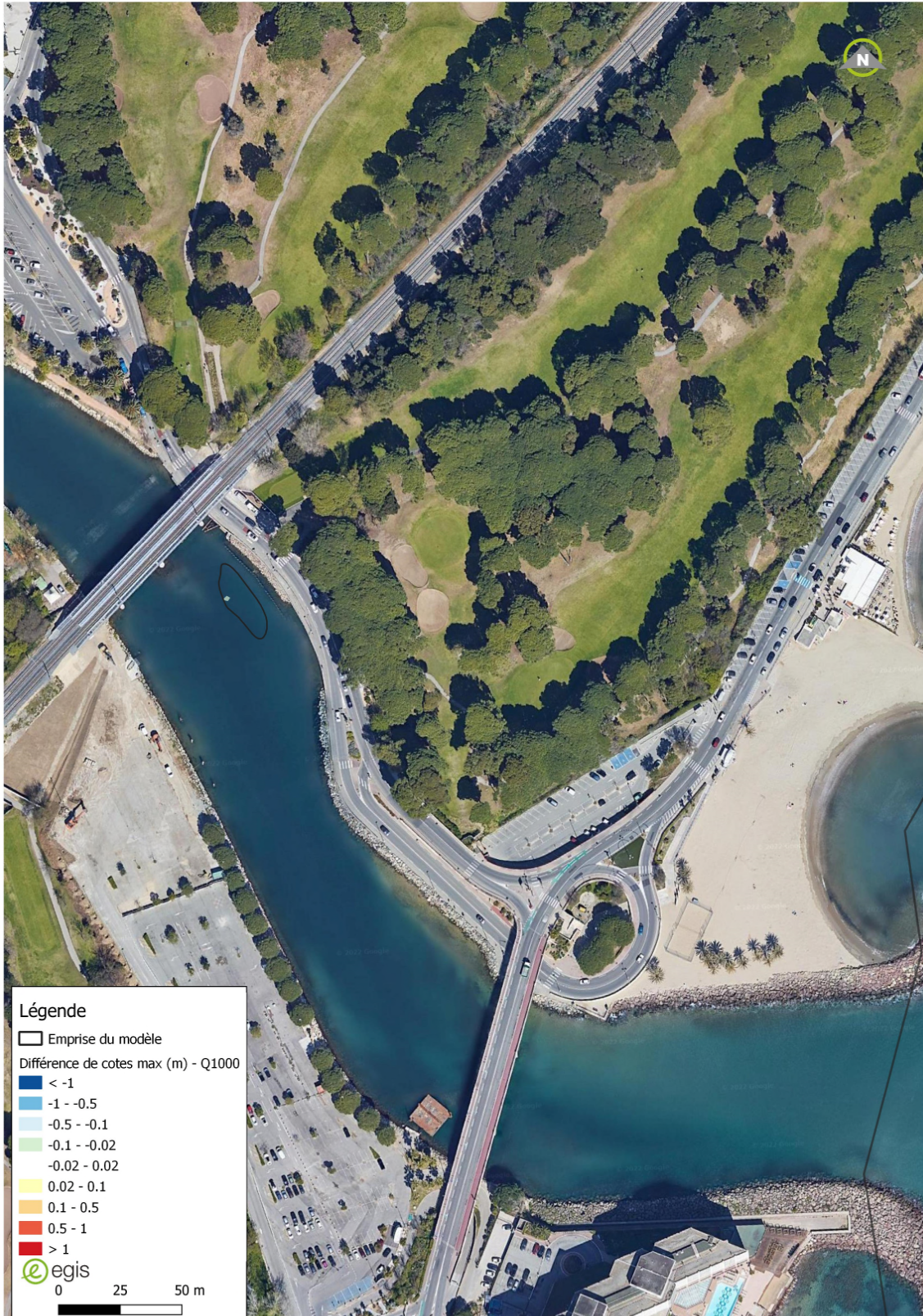
FIGURE 18: CARTOGRAPHIE DIFFERENCE DE NIVEAUX D'EAU APRES TRAVAUX AVEC / SANS COMBLEMENT DE LA FOSSE EN ENROCHEMENTS Q1000 (MODELE EGIS)
