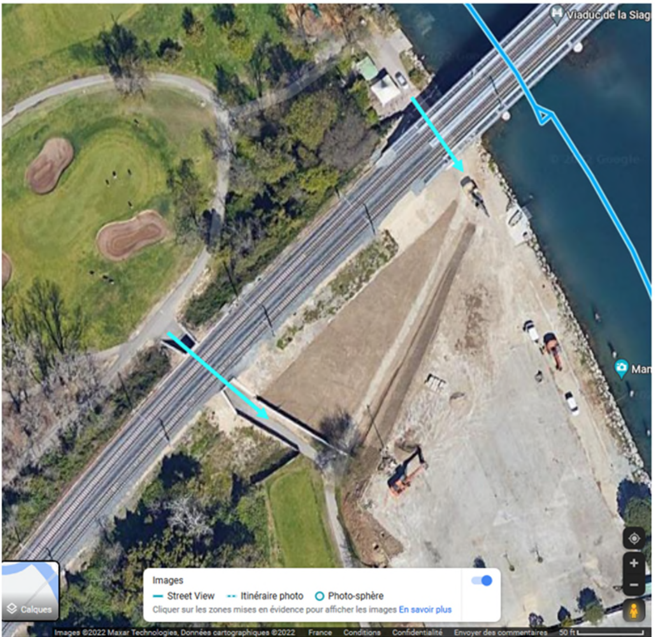
FIGURE 5: VUE DE LA ZONE DE POINTS BAS (DE 0,97 M A 0,91 M NGF) SOUS LE PONT SNCF RIVE DROITE ET D'UN OUVRAGE DE DECHARGE EN RIVE DROITE RECENT (SOURCE GOOGLE MAPS)
